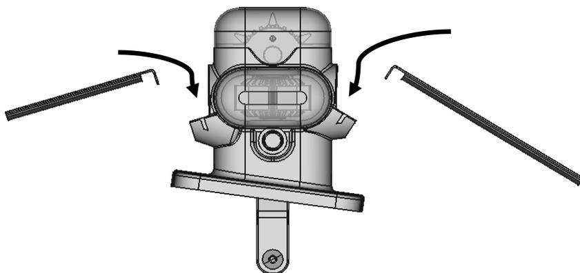
Insérer les rampes dans les encoches, la grande en entrée, la petite en sortie.
