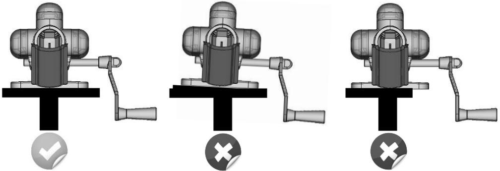
Poser la berlingotière sur le bord d'une table ou d'un plan de travail. La surface sur laquelle est posée la machine doit être plane. La berlingotière doit être bridée sur la table.
