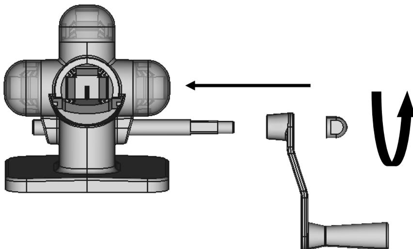
Insérer la poignée dans l'axe et visser l'écrou pour la bloquer.
